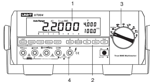
Figure 2-1. Meter Structure
