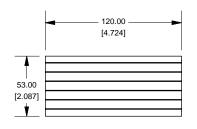
EXTRUSION DESIGNED FOR 100MM WIDE PC BOARD
