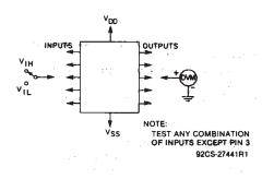
Fig. 30-Input-voltage test circuit.
