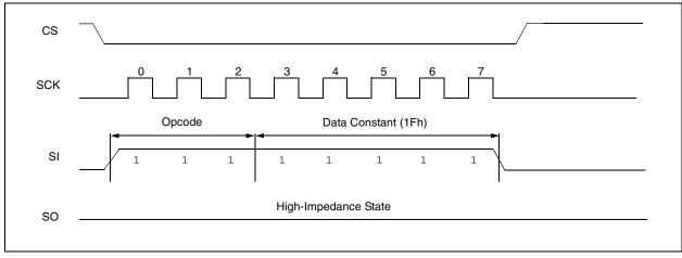
FIGURE 4-7: SYSTEM RESET COMMAND SEQUENCE
