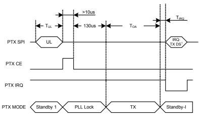
$T_{IRQ}$  = 8.2 $\eta$ s @ 1Mbps,  $T_{IRQ}$  = 6.0 $\eta$ s @ 2Mbps
