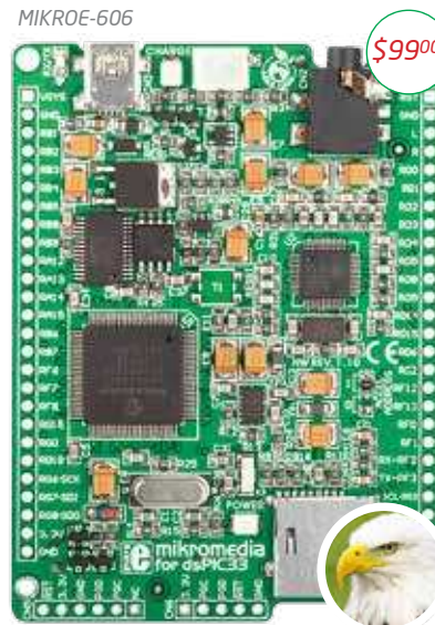
mikromedia for dsPIC33 (features dsPIC33FJ256GP710A)
