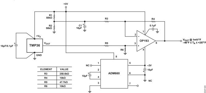
Figure 27. TMP36 Fahrenheit Thermometer Version 2
