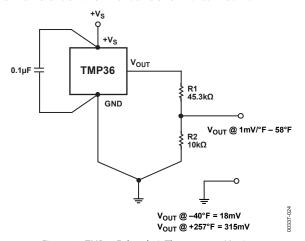
Figure 26. TMP36 Fahrenheit Thermometer Version 1
