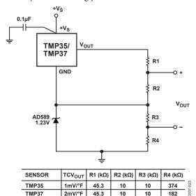
Figure 25. TMP35/TMP37 Fahrenheit Thermometers
