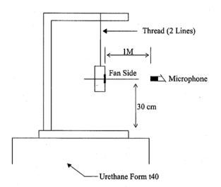
1 METER FROM MICROPHONE TO FAN INTAKE
