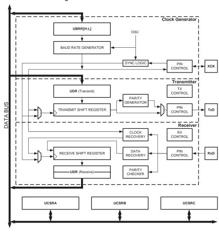
Figure 17-1. USART Block Diagram<sup>(1)</sup>
