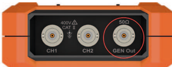
Figura 5 1: Porturi de ieşire ale generatorului
