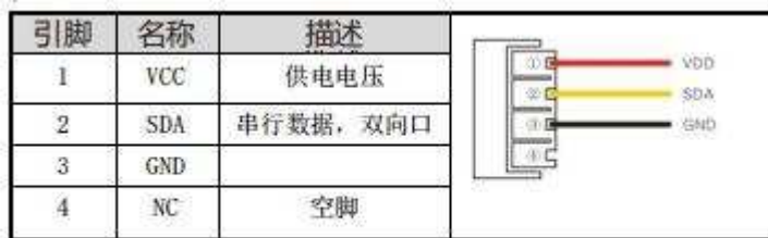
图7: AM2305B接线图
