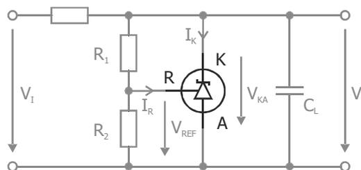
**Fig. 1** Testschaltung für Kennwerte/
