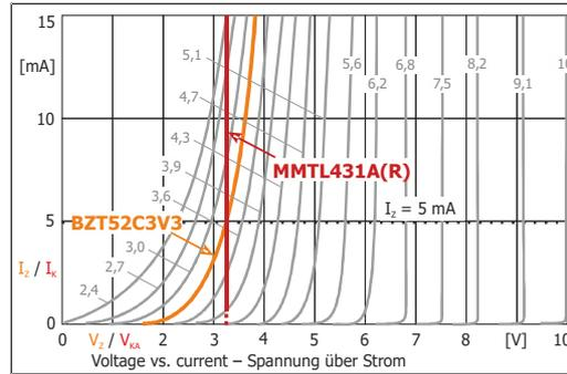
**Fig. 2** Ersatz für Z-Dioden mit niedriger Spannung
