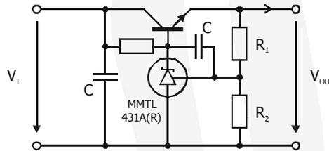
**Fig. 4** Präzisions-Spannungsregler
