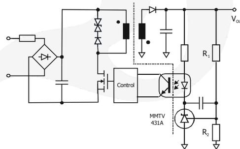
**Fig. 5** Regelung der Ausgangsspannung eines Sperrwandlers
