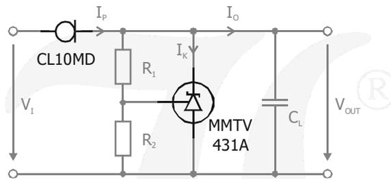
**Fig. 3** Spannungsversorgung mit geringem Bauteilbedarf für µController/Schaltungen mit niedrigem Eingangsstrom
