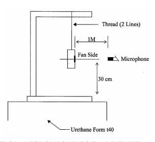
1 METER FROM MICROPHONE TO FAN INTAKE
