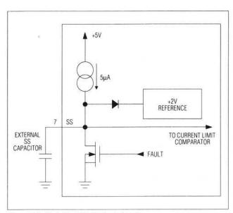
Figure 11. Soft-Start Equivalent Circuit
