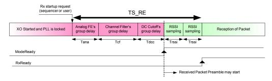
Figure 18. Rx Startup - No AGC, no AFC
