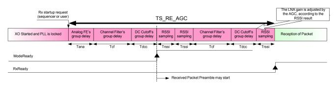
Figure 19. Rx Startup - AGC, no AFC
