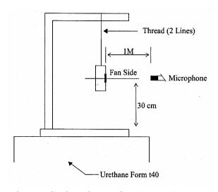
1 METER FROM MICROPHONE TO FAN INTAKE
