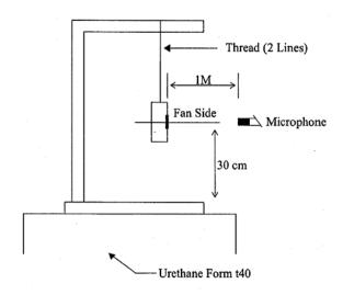
1 METER FROM MICROPHONE TO FAN INTAKE
