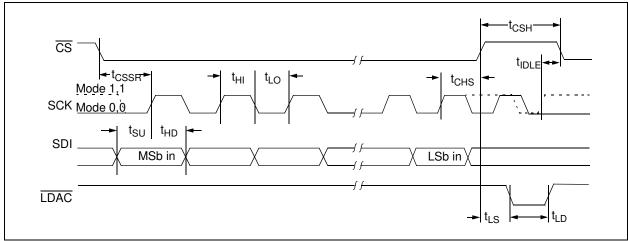
FIGURE 1-1: SPI Input Timing Data.
