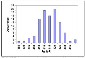
**FIGURE 2-17:**  $I_{DD}$  Histogram ( $V_{DD} = 5.0V$ ).
