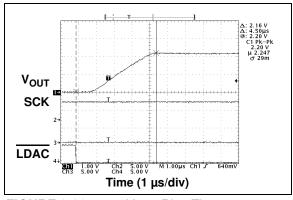
**FIGURE 2-30:**  $V_{OUT}$  Rise Time.
