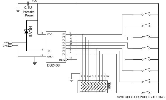
Figure 22. DS2408 AS MULTIPURPOSE SENSOR/ACTUATOR
