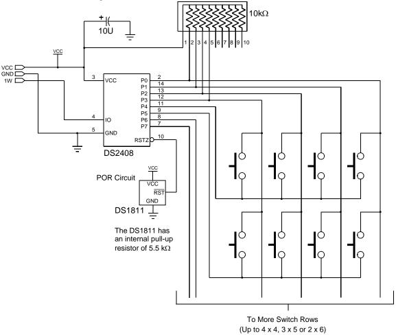
Figure 21. DS2408 AS PARASITE-POWERED PUSH-BUTTON SENSOR
