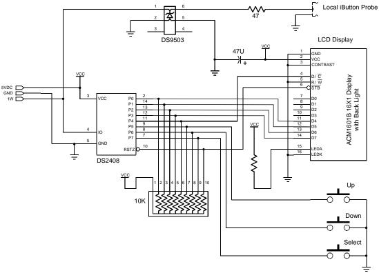
Figure 19. DS2408 AS MICROCONTROLLER PORT EXPANDER
