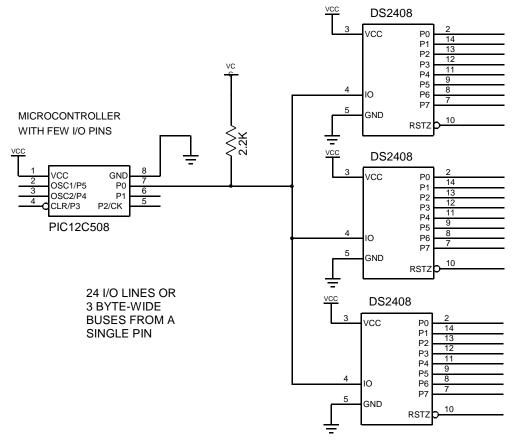
Figure 20. DS2408 AS μC-OPERATED KEYBOARD SCANNER
