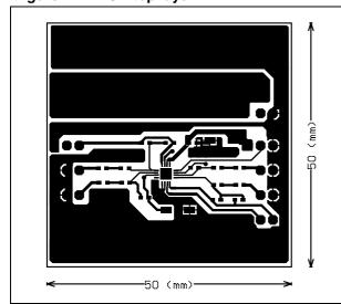
Figure 3. PCB bottom layer
