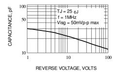
Fig. 5-TYPICAL JUNCTION CAPACITANCE
