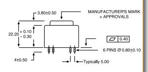
\*\* RECOMMENDED DRILL-HOLE DIAMETER FOR 1,3 mm PINS
